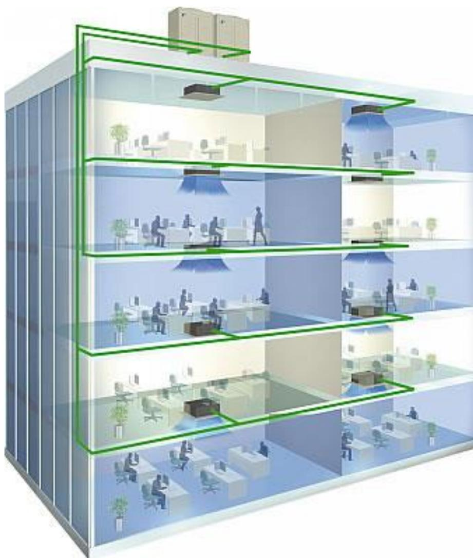
**Figura 7:** Desenho esquemático de sistema VRV
